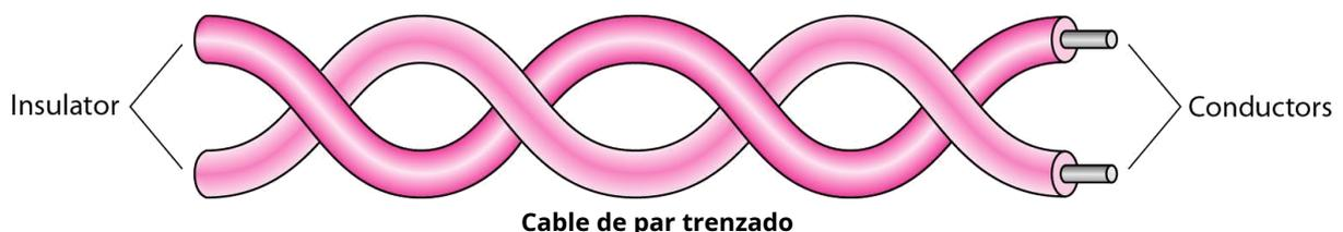
Las líneas de transmisión de par trenzado también son el medio de transmisión elegido para la mayoría de las redes de área local porque el cable de par trenzado es fácil de instalar y relativamente independiente en comparación con los cables coaxiales y de fibra óptica.
